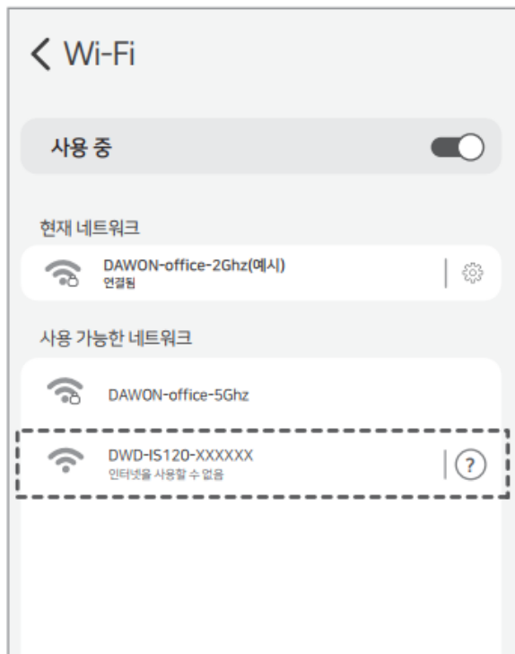
8. Wi-Fi 목록에서 DWD-IS120-XXX로 시작하는 장치를 선택 해주세요. * 뒤 6자리는 설치하시려는 제품 뒷면 라벨의 맥번호 확인
